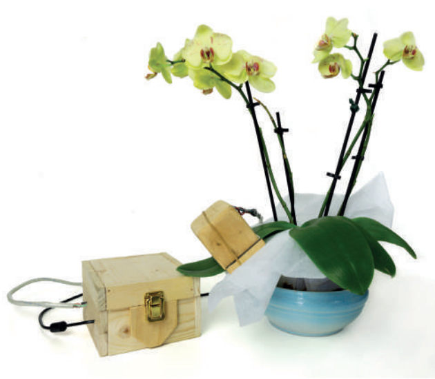
Prototipo del fluorimetro con la sonda posizionata sulla foglia di un’orchidea
